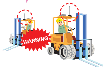
検知機&車両用タグを設置
