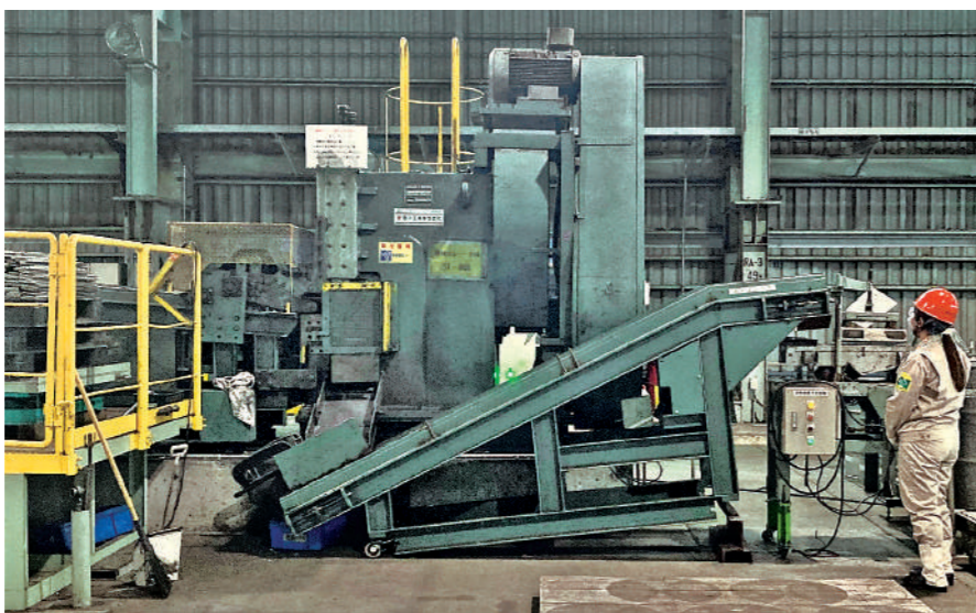
チタンスクラップを出荷先で使いやすいサイズに切り分けるせん断機④、加工後はドラム缶に詰めて出荷する
