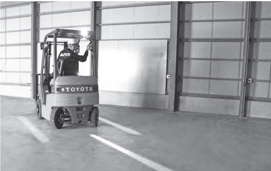
PCS(株)の「LEDラインライト」床面にLEDライトの光線が投影
